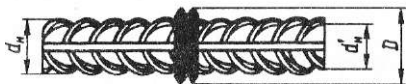
Рис. 5.4. Конструктивні елементи зварних стикових з'єднань без усунення грату та після механічної обробки: d'_n, a_n - діаметри меншого та більшого стрижнів відповідно; l - діаметр грату
